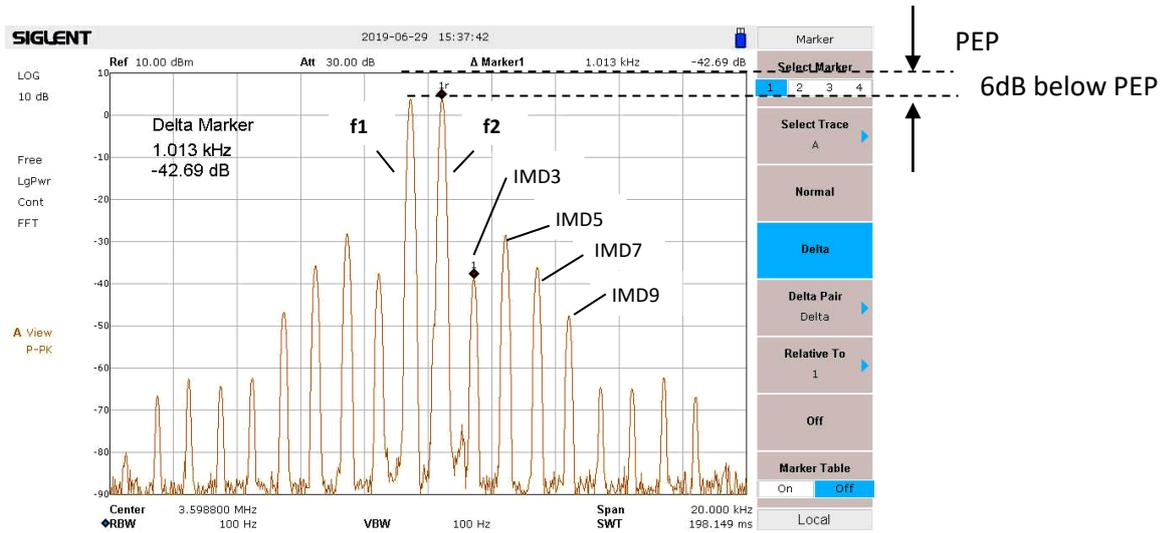
Figure 15 3.6MHz: IMD3=42.6dBc, IMD5=32dBc, IMD7=40dBc, IMD9=50dBc
