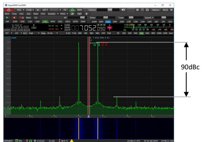
**$P_i=2 \times -20\text{dBm}$ , Bandpass-Filter On,  $\text{IMD}_3=80\text{dBc}$
