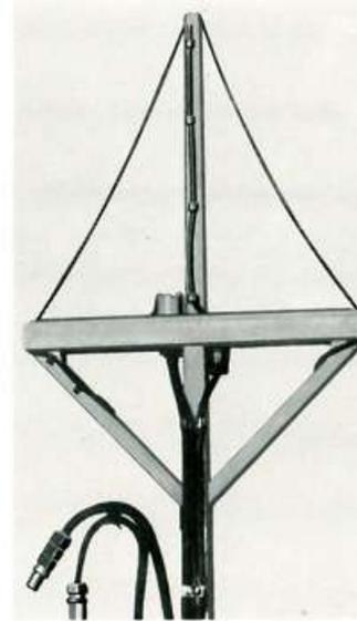
Erste FuMB-Anlage für U-Boote mit Empfänger FuMB 1 „Metox“ und Antenne „Biskayakreuz“
